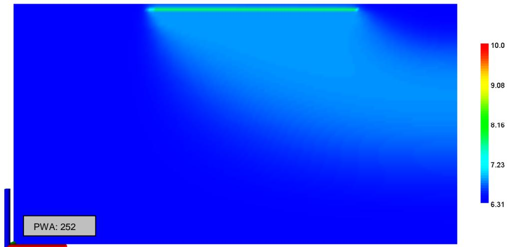
Abb. 15: Das PHAST-Blockmodell; Ergebnisse der Berechnungen mit den Eingabedateien Erweitert.chem und Erweitert.trans; dargestellt ist der pH-Wert in den Porenwässern des BHV-Bereichs und in dessen Abstrom zum ‚Röhrensystem‘ für die jeweils angegebene Anzahl der PWA; die farbig markierte pH-Wertskala reicht von 6,3 (im Tiefengrundwasser) bis zu 10,0; vgl. Abbildung 8.
