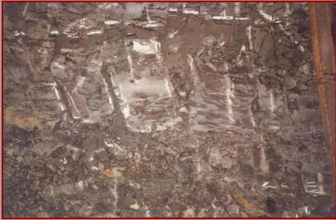
Abb. 24: Nahaufnahme einer Ortsbrust im Bergwerk Walsum. Gefüge aus Bruchbergen und Füllstoff nach Einbau über Schlepprohr (Steinkohlenbergbauverein Essen 1988, Thiehofe 1991)
