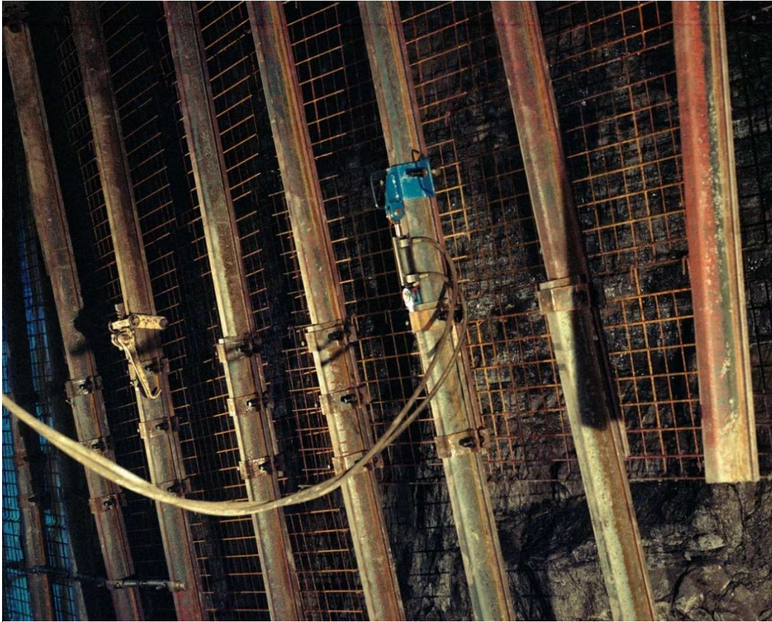
Abb. 12: Hydraulische Anbindung des Röhrensystems an das Gebirge aufgrund eines offenen Ausbaus (Foto: RAG)
